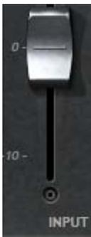
**Фейдер «Input Sensitivity»:** используется для установки оптимального уровня входного сигнала плагина.
