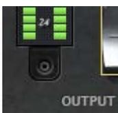
**Индикатор выходного сигнала:** отображает пиковый уровень выходного сигнала.
