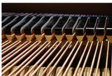
Звук в фортепиано извлекается ударом молоточка о струны. В нейтральном положении струны, кроме последних полутора—двух октав, соприкасаются с демпферами (глушителями). При нажатии клавиш в действие приводится устройство из рычагов, ремешков и молоточков, называемое *фортепианной механикой*. После нажатия от соответствующего хора струн отходит демпфер, чтобы струна могла свободно звучать, и по нему ударяет молоточек, обитый фильцем (войлоком).
