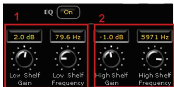
Секция **EQ** включает двухполосный полочный фильтр с усилением (от -24 dB до +24 dB) и частотой (от 20 Гц до 10 кГц) на каждую полосу. Секция **Low Shelf** [1] управляет частотой фильтра и усилением основания спектра, а секция **Hi Shelf** [2] управляет вершиной спектра.
