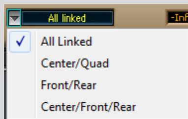
Селектор **Link Mode** обеспечивает выбор одного из пяти доступных режимов привязки. Он расположен непосредственно под секцией индикаторов **Attenuation**. Режим привязки определяет, какие каналы будут привязаны к определенному **sidechain** сигналу. Выбор режима привязки будет влиять на цвет контроллеров **Threshold** и **Ceiling**, которые изменят цвет соответствующей группы, связанной с этим **sidechain** сигналом.
