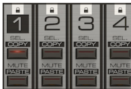
Навесные замки, которые позволяют блокировать определенные линии задержки
