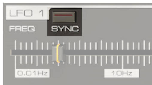
Включение режима синхронизации с темпом для LFO
