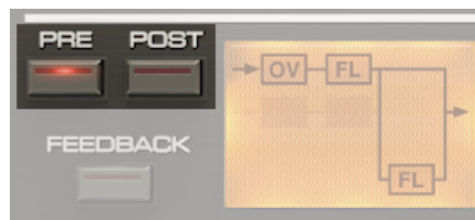
Режимы Pre и Post для резонансного фильтра
