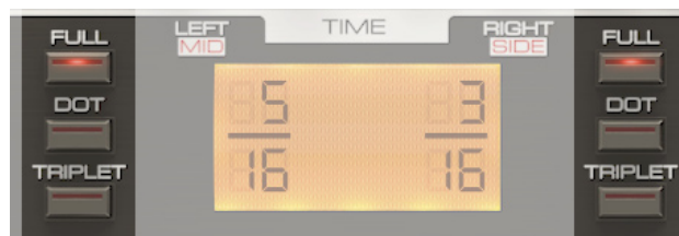
Модификаторы ритмических значений в режиме синхронизации с темпом
