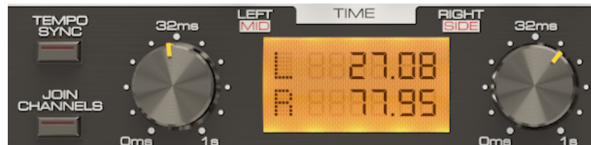
Подсекция Time с отключенной синхронизацией с темпом
