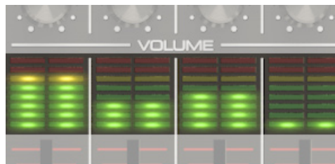
VU-измерители показывают уровень выходного сигнала на линиях задержки
