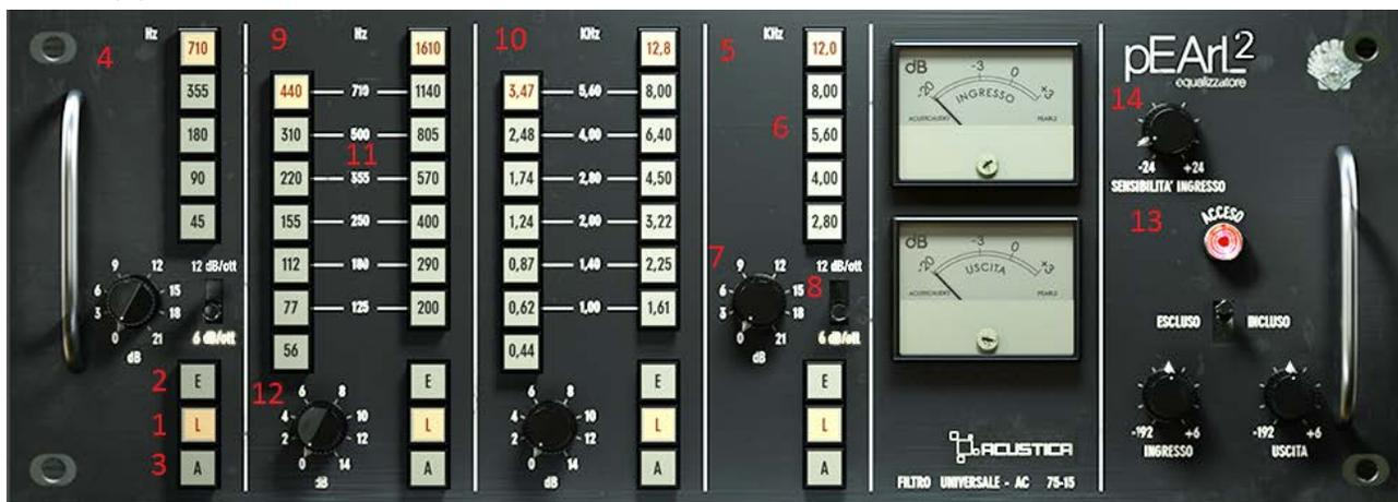
Узел фильтра представляет собой систему, состоящую из шести модулей. Седьмой модуль содержит входные и выходные усилители.
